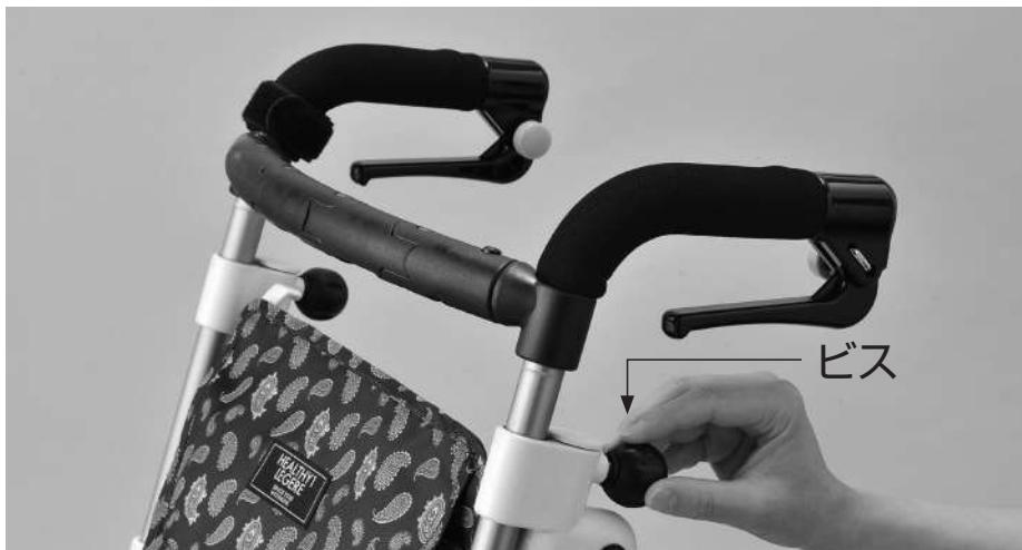
持ち手の高さは4段階に調節できます。調節するときは、ビス（写真矢印部・左右にあります）を左に回してゆるめます。ビスの下のフレーム外側にある
