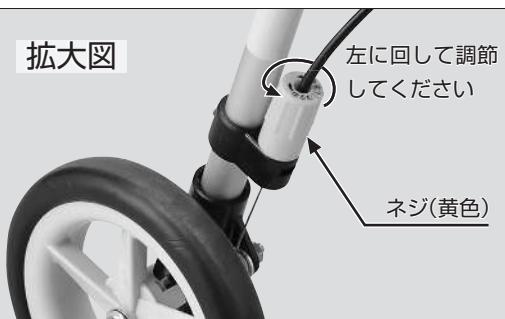
手元ブレーキが効きにくくなったり、駐車用ストッパーが車輪に当たって音がする場合は、後輪上部左右にあるネジ(黄色)を左に回して調節してください。
