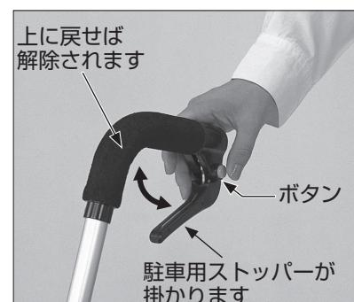
手元ブレーキレバー内側のボタンを押すと駐車用ストッパーが掛かります。手元ブレーキレバーを引き上げてはなすとストッパーが解除され、歩行開始の状態に戻ります。
