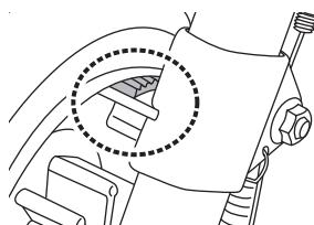
※アウターボルトが最高位置に達する場合、下記のようにブレーキワイヤーを引っ張り調整してください。
