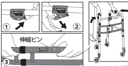
折りたたむ時は、図①赤の安全ロックを解除し図②ロックレバーを矢印の方向に下げて、図③伸縮ピン位置を3または4に合わせて下さい。ロックが解除されていないと折りたたむ事ができません。
