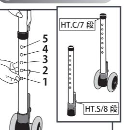
高さ調節ピンを押さえ脚を上または下に動かしてください。調節した後ピンが出ていることを確認してください。
