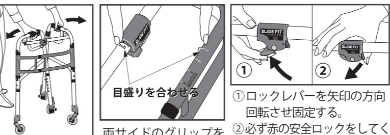
組立てる時は、両サイドのグリップを最後まで開き下段パイプの目盛に合わせて、ロックレバーで固定してください。
