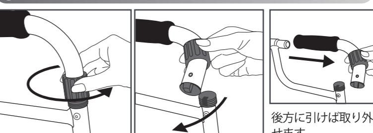
グリップを交換する時は、リングねじが緩んだら図のように内側に回転させてください。
