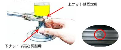
①天板を開き、上から見た時、上端側スロープの下端ラバー部が上端側スロープ受けと一致して見える位置までジョイント台を
