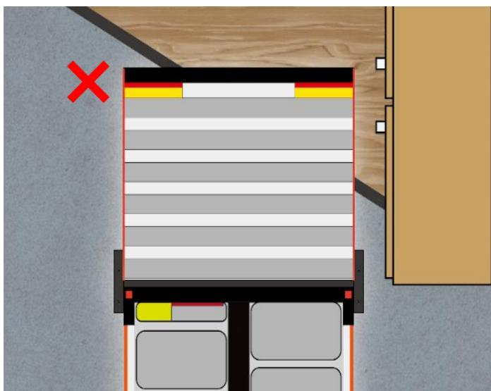
○ フラップ先端4cm以上(設置シールの赤ライン部分)が、設置場所に全て乗っている。
