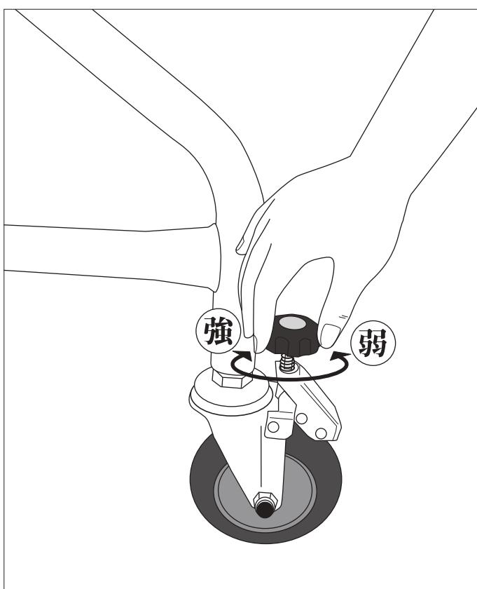
①調節ツマミは右回転させると抵抗が強くなり、左回転させると弱まります。
