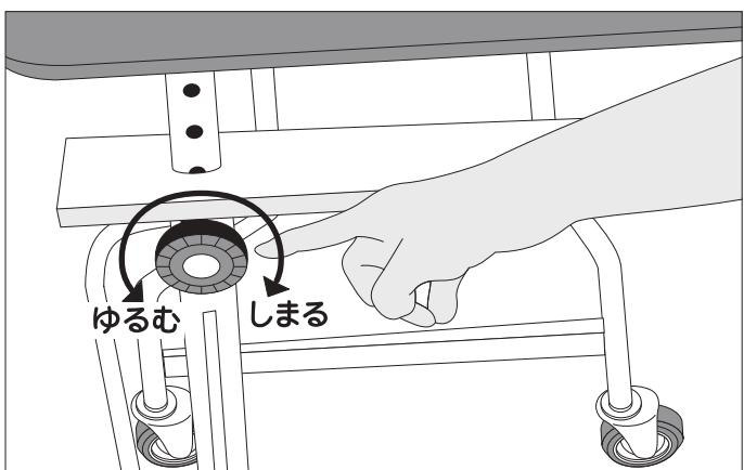
①本体フレームの上部にあるノブねじを緩めてマット支柱が上下に動くようにして下さい。
