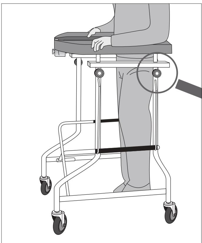
③高さが決まればノブねじを締めてマット支柱を4箇所すべて同じ高さで固定します。
