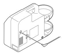
2 シガーライターを車のシガーライターソケットに接続してください。
