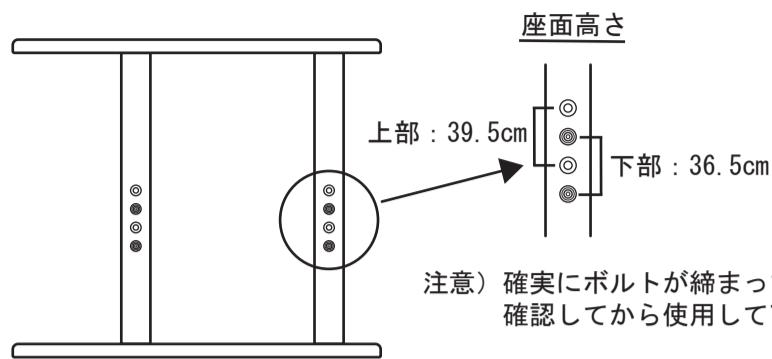
注意) 確実にボルトが締まっていることを確認してから使用して下さい。
