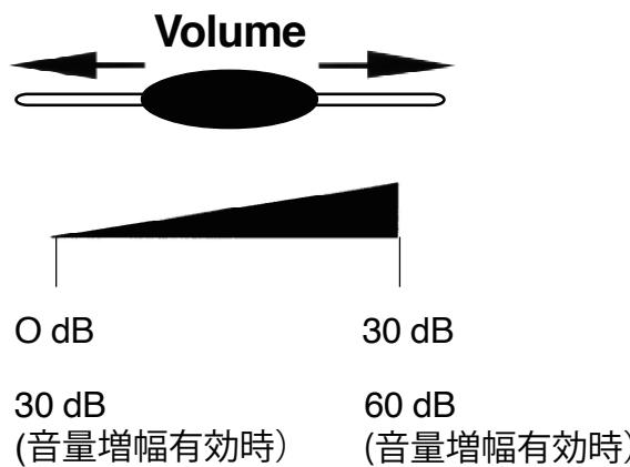
P3 ⑯ の音量/音程スイッチ
