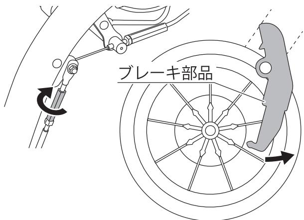
**5** 左右の調節ネジを反時計回りに回し、ブレーキ部品と後輪ホイールが当たる位置まで調節してください。(目安: 調節ネジの手ごたえが軽くなります。)
