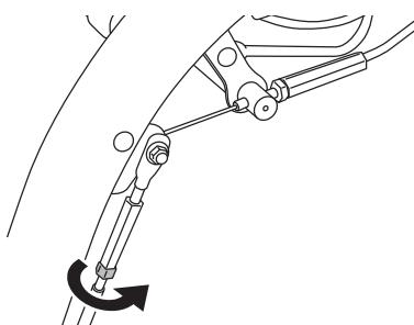
**8** 六角ナット 1 を車体後方から見て反時計回りに回して締めてください。
