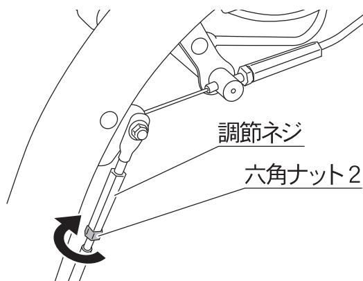
**4** 左右の調節ネジを時計回りに回して、ブレーキ部品をタイヤ中央から離してください。
