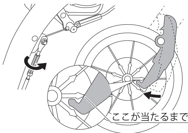
**6** 調節後、左右片側ずつ及び両側グリップの操作、ハンドブレーキの操作を行い、動作に問題がないことを確認してください。調節が不十分な場合、調節手順 1 **2** の調節を再度行ってください。
